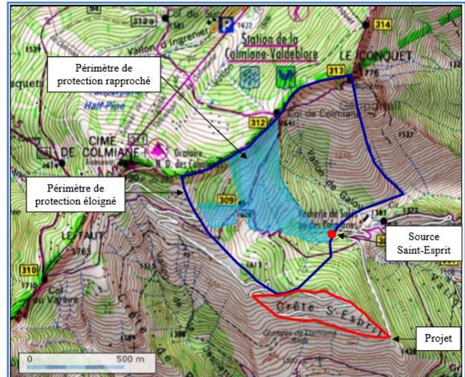
Figure 27 : Périmètres de protection rapproché et éloigné de la source de Saint-Esprit (source : BRGM)
