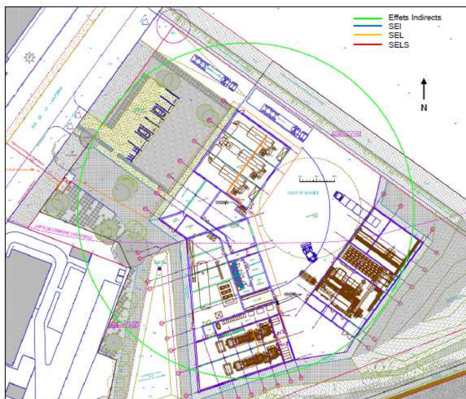
Fuite sur alimentation gaz de la chaufferie à l'extérieur : effets de surpression
