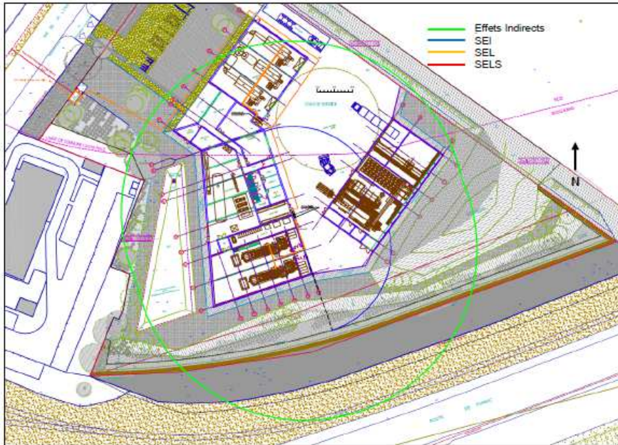
Fuite sur alimentation gaz de la cogénération à l'extérieur : effets de surpression
