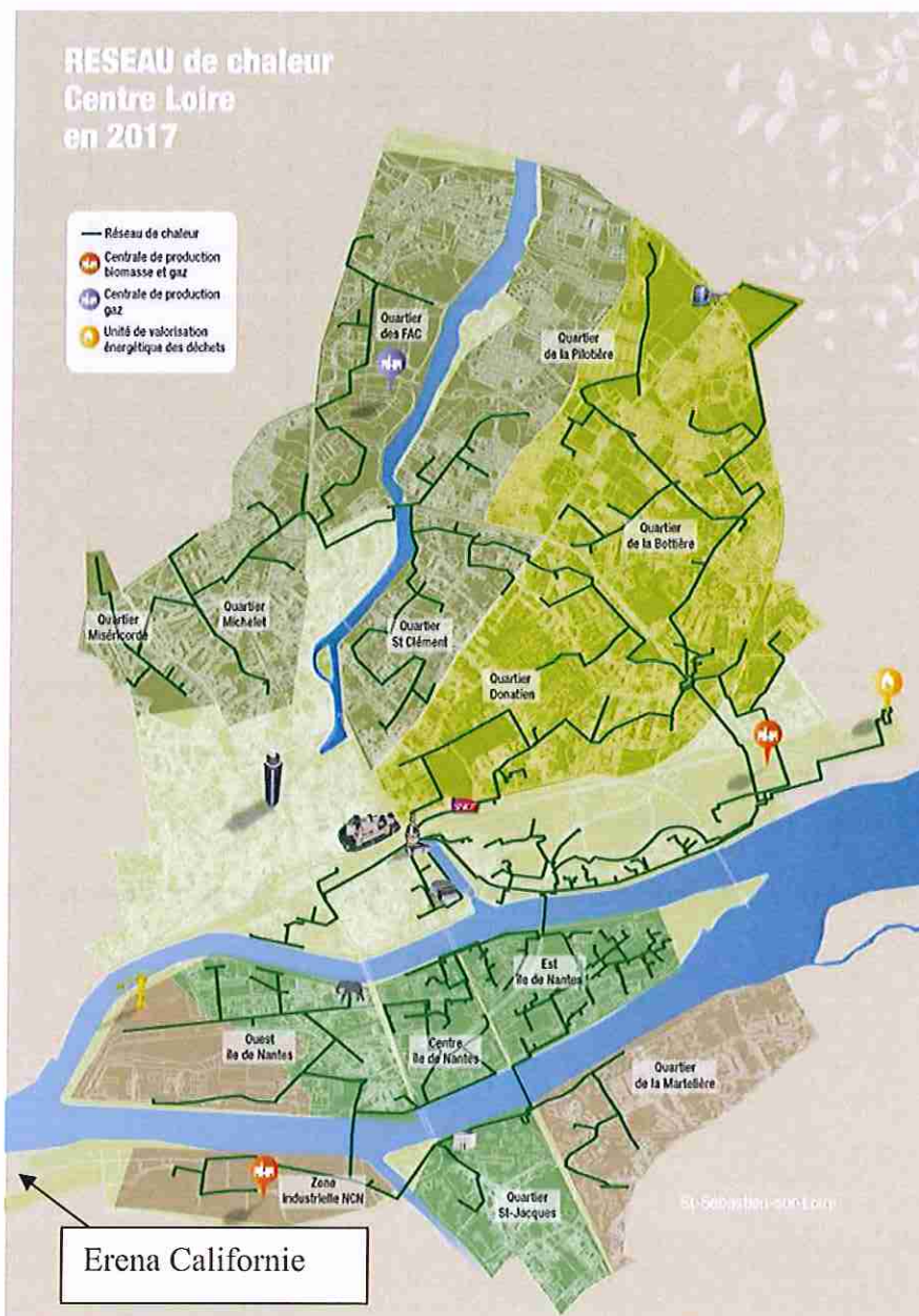
Extension du réseau de chaleur de Nantes Métropole
