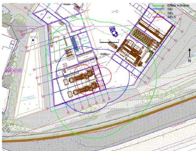
Fuite sur alimentation gaz à l'intérieur de la cogénération : effets de surpression
