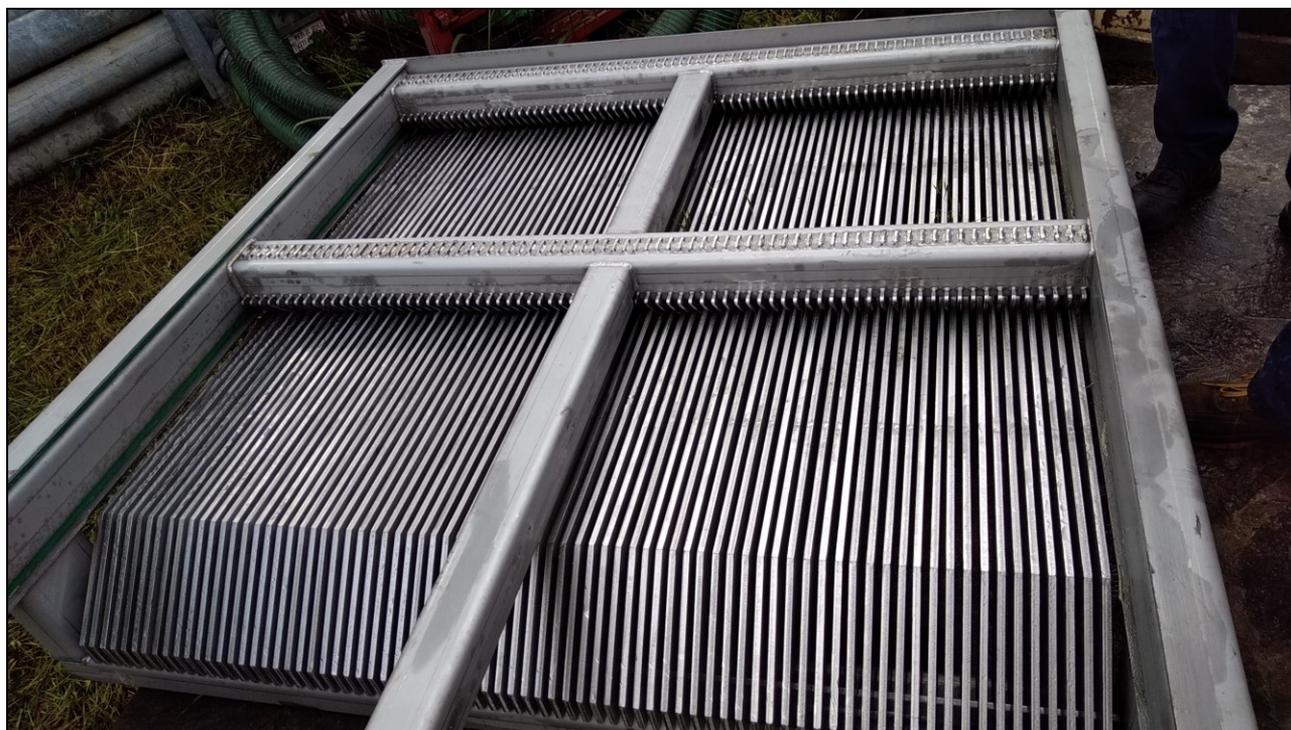
**Figura 3.2 – Sistema di grigliatura del refluo sfiorato installato sulla stazione di sollevamento "Campagnola" di Valeggio.**
