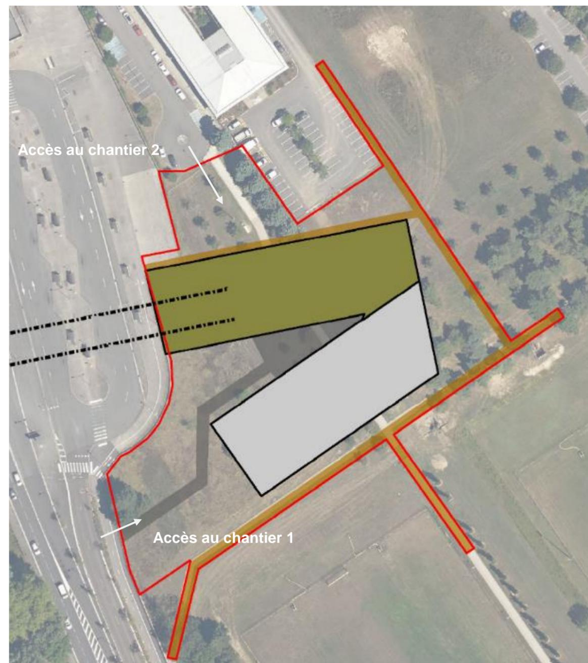
Figure 5 : Plan de la zone travaux de la station UPS (Source : Groupement POMA, 2018)
