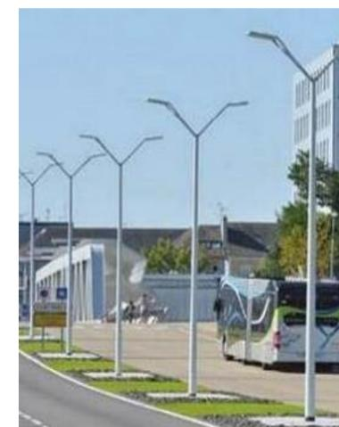
Figure 25 : Photo d'un candélabre type « Karo » (source AREA)
