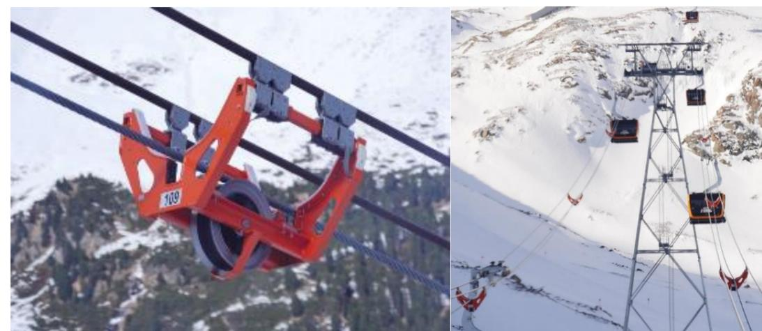
Figure 35 : A gauche = photo de cavalier. A droite = exemple d'insertion des cavaliers sur les câbles (Source : Groupement POMA)
