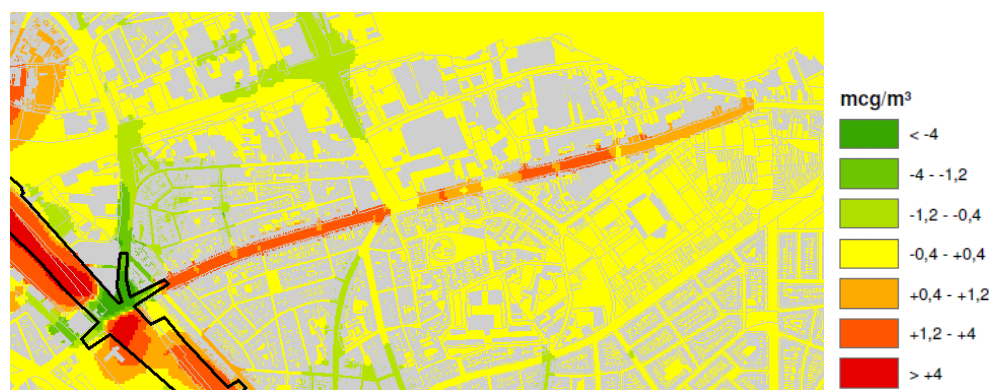
Figuur 8-62 NO 2 -bijdrage t.h.v. Bisschoppenhoflaan na snelheidsverlaging op R1
