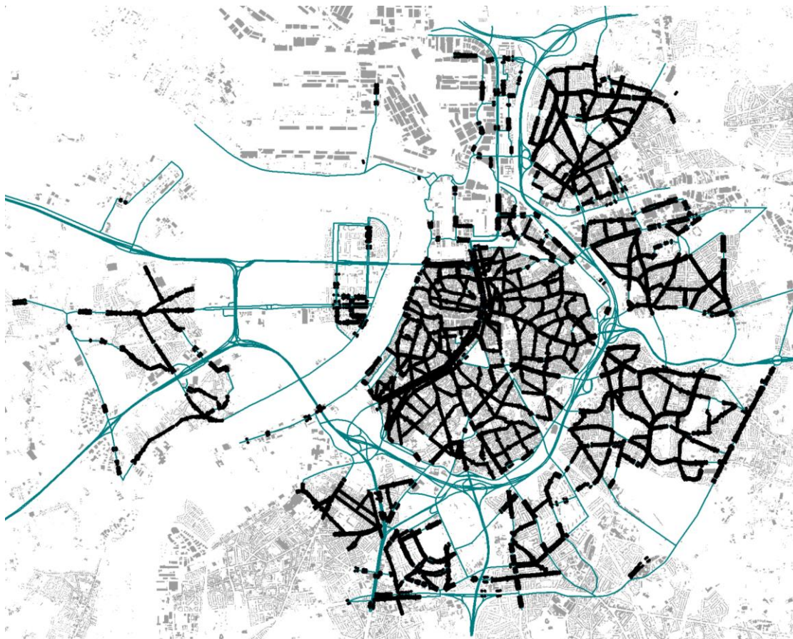
Figuur 8-2 Automatische selectie “street canyons” op netwerk (dikke zwarte punten, bron: VITO)
