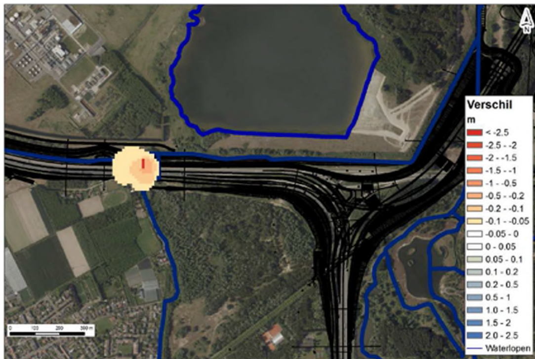
Figuur 11.27 Verandering freatische grondwaterstand door bemaling bij kunstwerk K05. Een negatieve verschilwaarde geeft een daling van de grondwaterstand aan.
