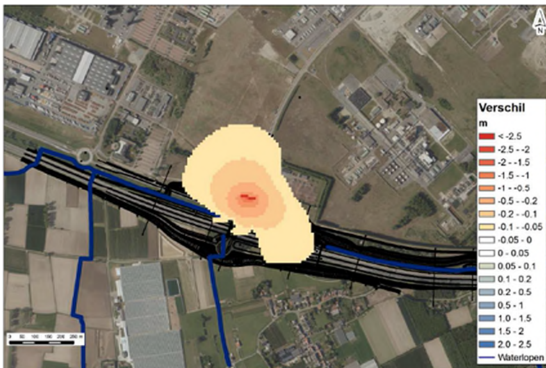
Figuur 11.29 Verandering freatische grondwaterstand door bemaling bij kunstwerk K28. Een negatieve verschilwaarde geeft een daling van de grondwaterstand aan.
