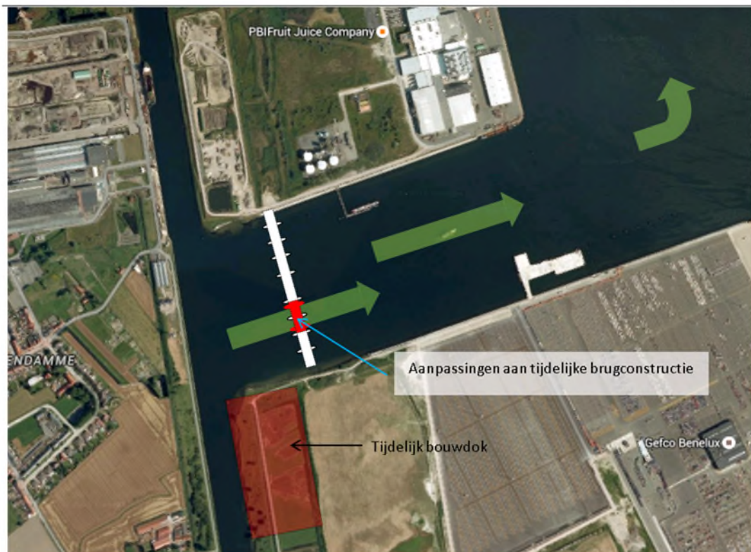
Figuur 3-11: situatie doorvoer tunnelementen
