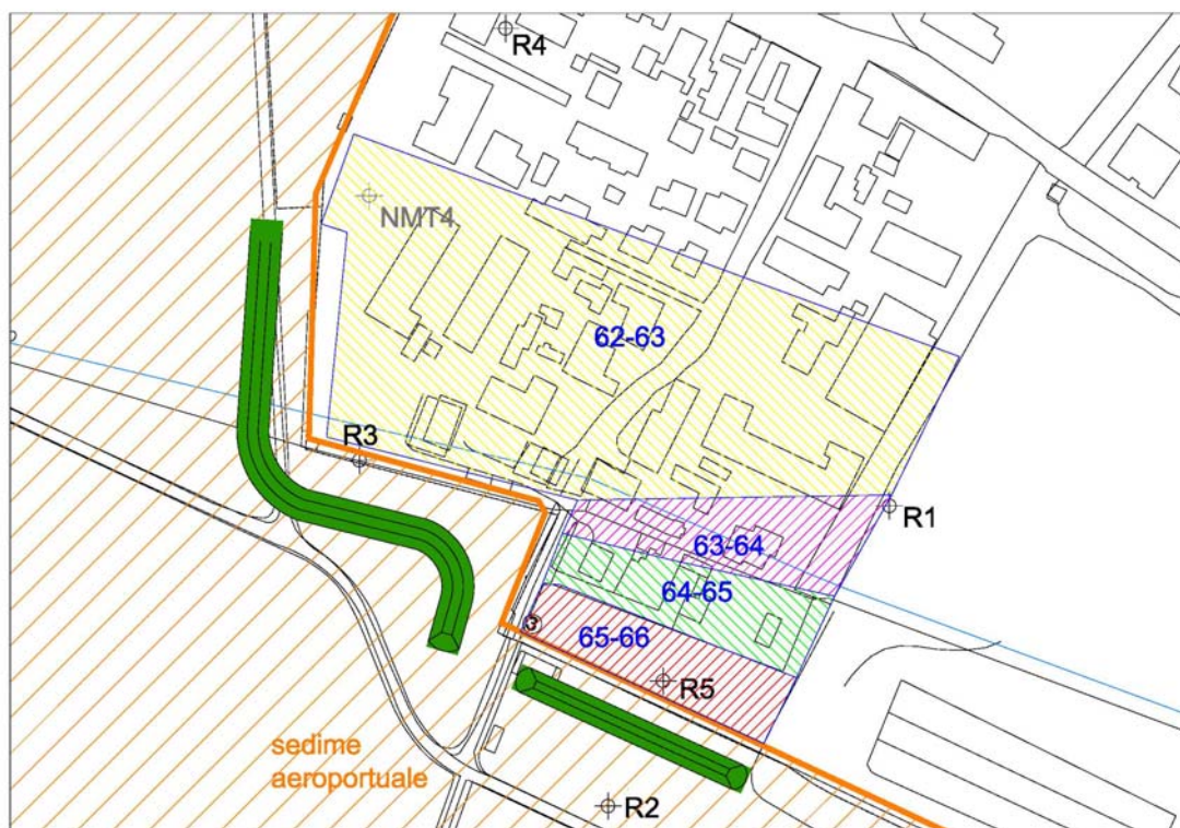
Img. 5.18 - Elaborazione grafica dell'effetto schermante della barriera antirumore
