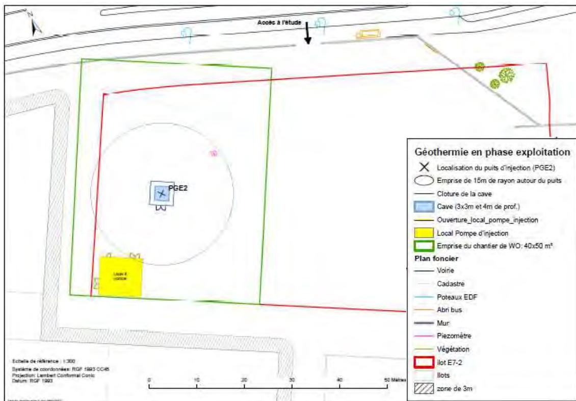
Figure 97 : Localisation du piézomètre existant sur PGE2 (source : Storengy)
