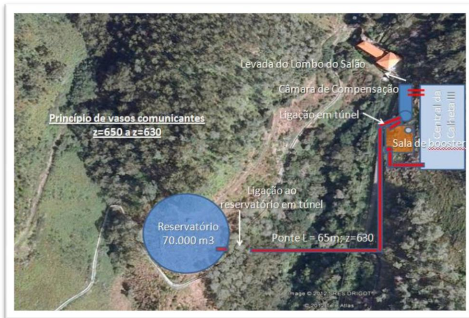
Reservatório de Restituição da Calheta/Corruchéu
