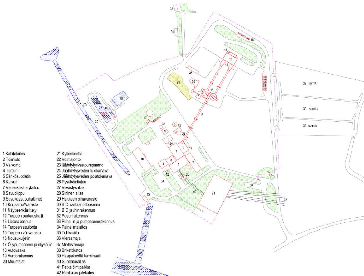
Kuva 3-1. Haapaveden voimalaitoksen asemapiirros.
