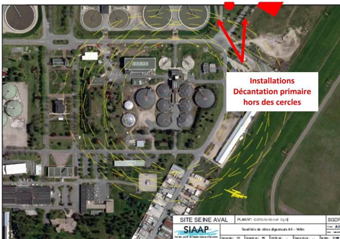
Figure 63 : Seuil bris de vitres explosion digesteurs AII - (Source : étude de danger SAV décembre 2016)
