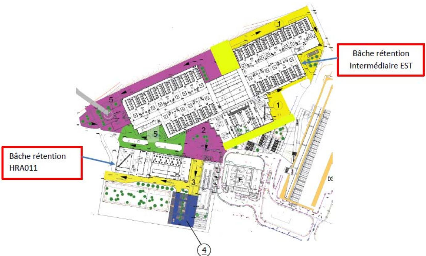
Figure 43 : Ecoulement des eaux pluviales selon les zones des ouvrages
