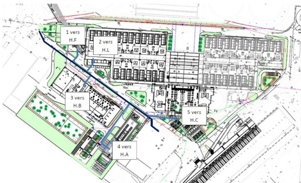
Figure 25: Localisation des 5 points de piquages sur le réseau d'eau potable existant
