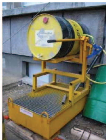
Figure 16 : Bac de rétention pour fût de produits chimiques
