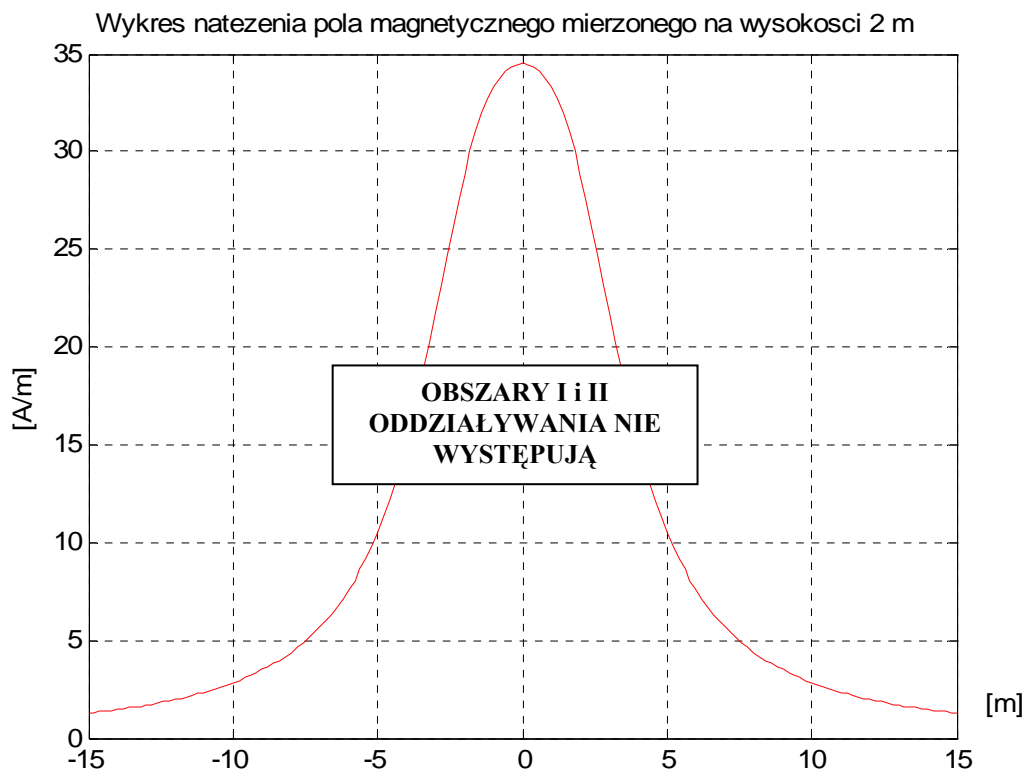
Rys. B-4. Wykres natężenia pola magnet. w polu linii i transformat. 110 kV Oszynowanie rurowe AR 80/6 na wysokości 4,30 m
