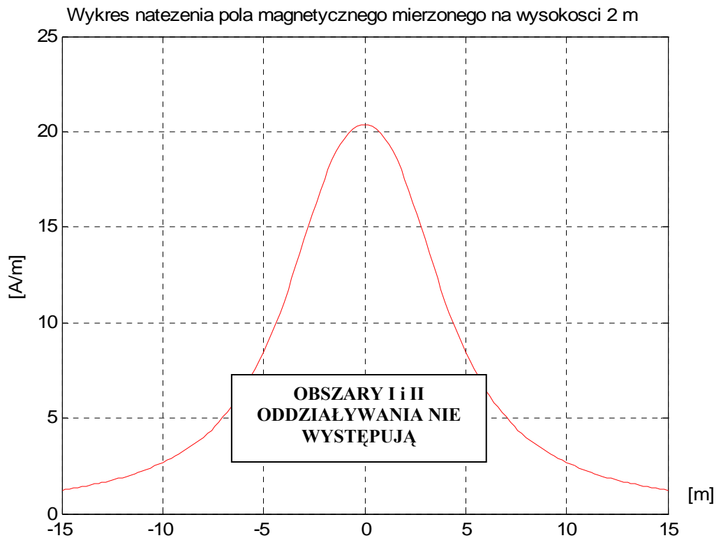
Rys. C-4. Wykres natęż. pola magnet. w polu łącznika szyn (sekcji) 110kV Oszynowanie rurowe AR 80/6 na wysokości 5,30 m
