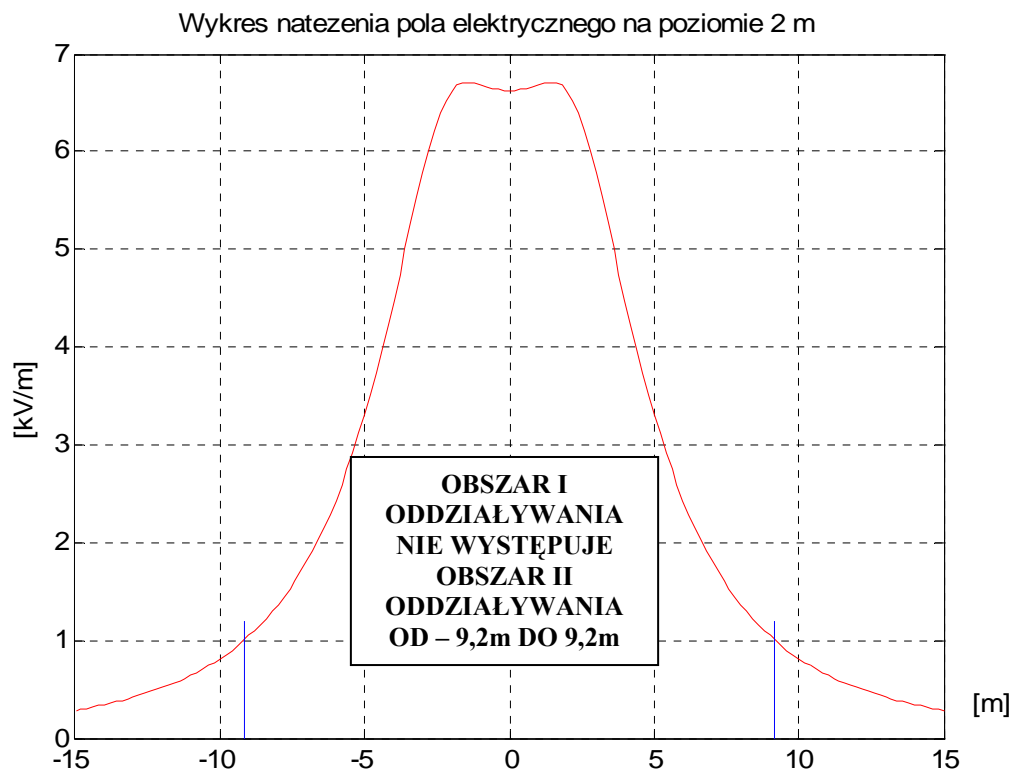
Rys. B-2. Wykres natężenia pola elektr. w polu linii i transformat. 110 kV Oszynowanie rurowe AR 80/6 na wysokości 4,30 m
