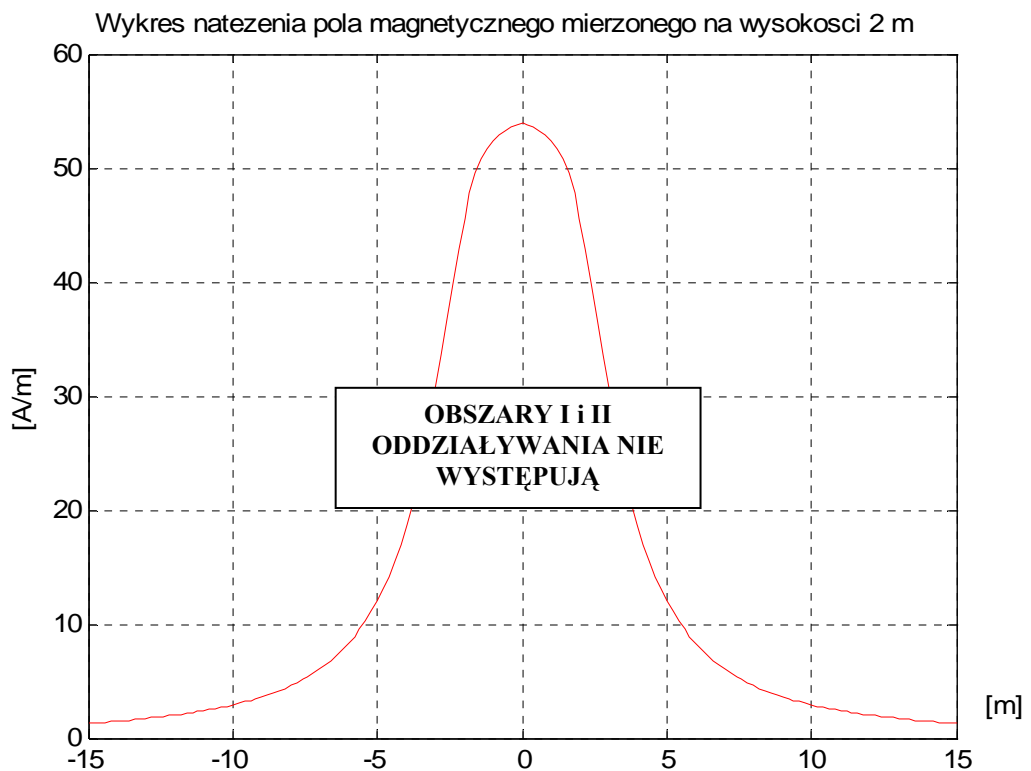
Rys. A-4. Wykres natężenia pola magn. w polu linii i transformat. 110 kV Przewody AFL-6 o przekroju 240\text{mm}^2 na wysokości 3,60m
