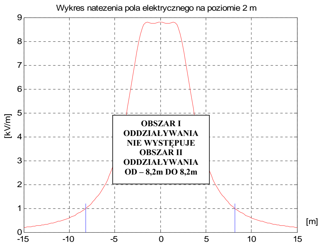
Rys. A-2. Wykres natężenia pola elektr. w polu linii i transformat. 110 kV Przewody AFL-6 o przekroju 240\text{ mm}^2 na wysokości 3,60 m
