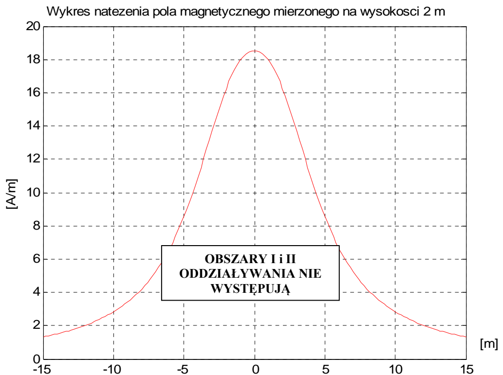
Rys. D-4. Wykres natężenia pola magn. w stanowisku transformat. 110 kV Oszynowanie rurowe AR 80/6 na wysokości 5,60 m
