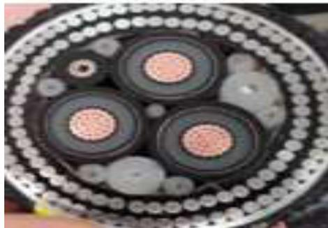
**Figure 2: image d'illustration coupe transversale d'un câble sous marin**
