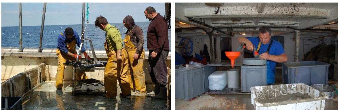
*Photographie 43 : Prélèvements de macrobenthos à l'aide de la benne DayGrab et analyse des échantillons
