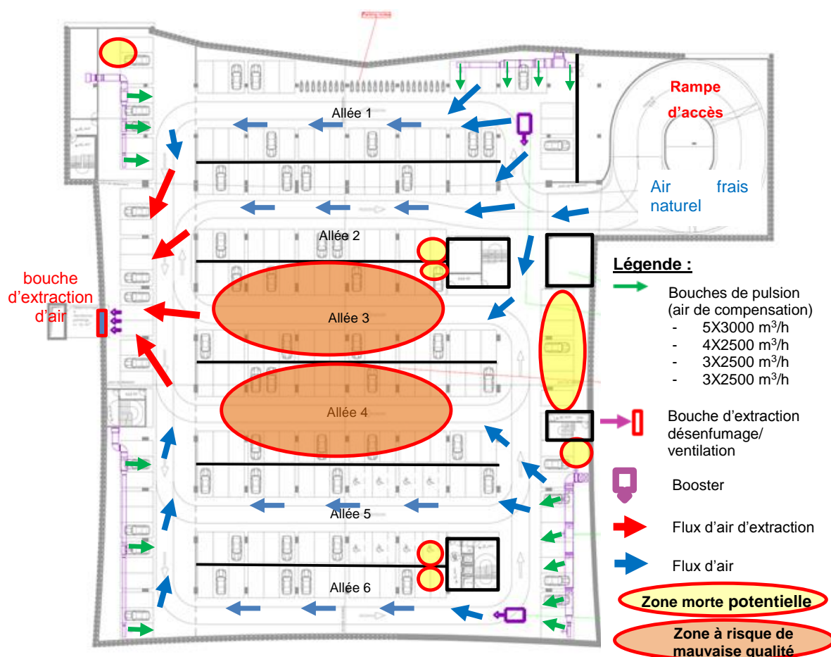
Figure 14 : Schéma de ventilation du parking et évaluation des zones mortes (niveau -2) - plan de la demande de permis
