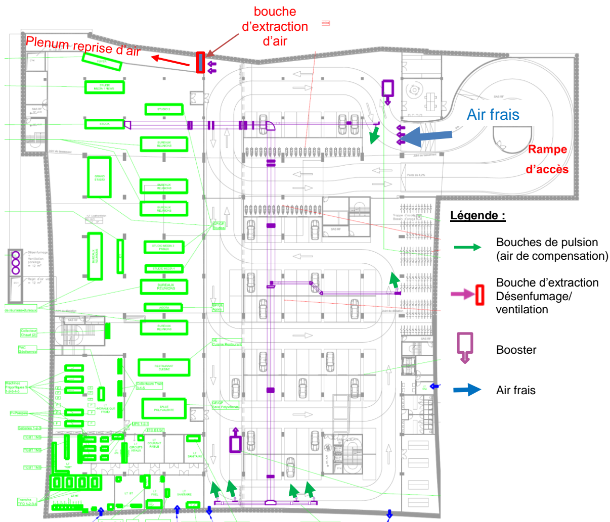
Figure 12 : Vue du niveau -1 du parking souterrain (Source : Plan initial – demande de permis)
