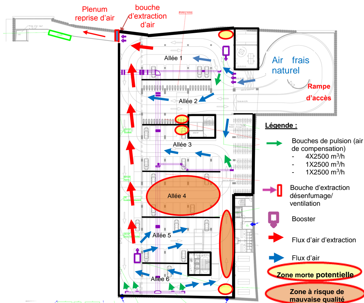
Figure 13 : Schéma de ventilation du parking et évaluation des zones mortes (niveau -1) – plan de la demande de permis
