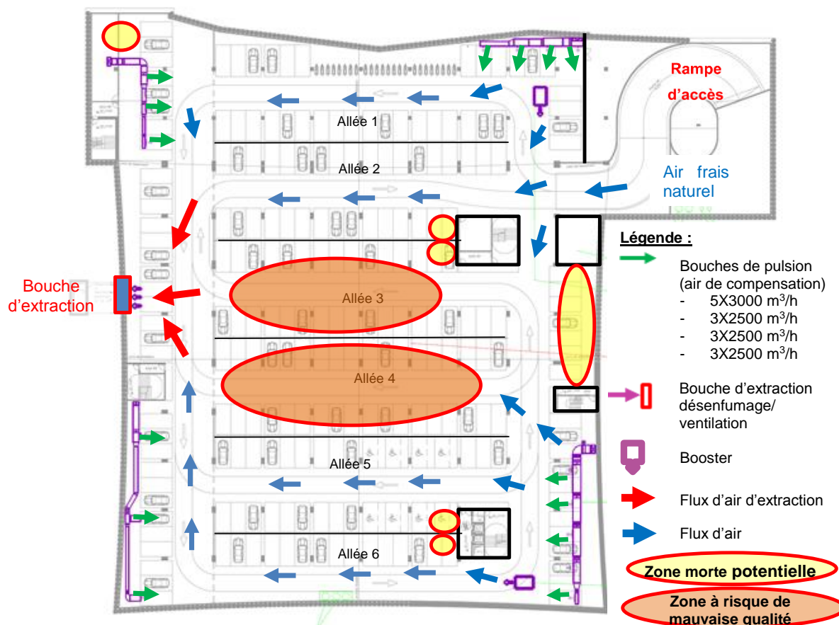
Figure 15 : Schéma de ventilation du parking et évaluation des zones mortes (cas du niveau -3) - plan version permis
