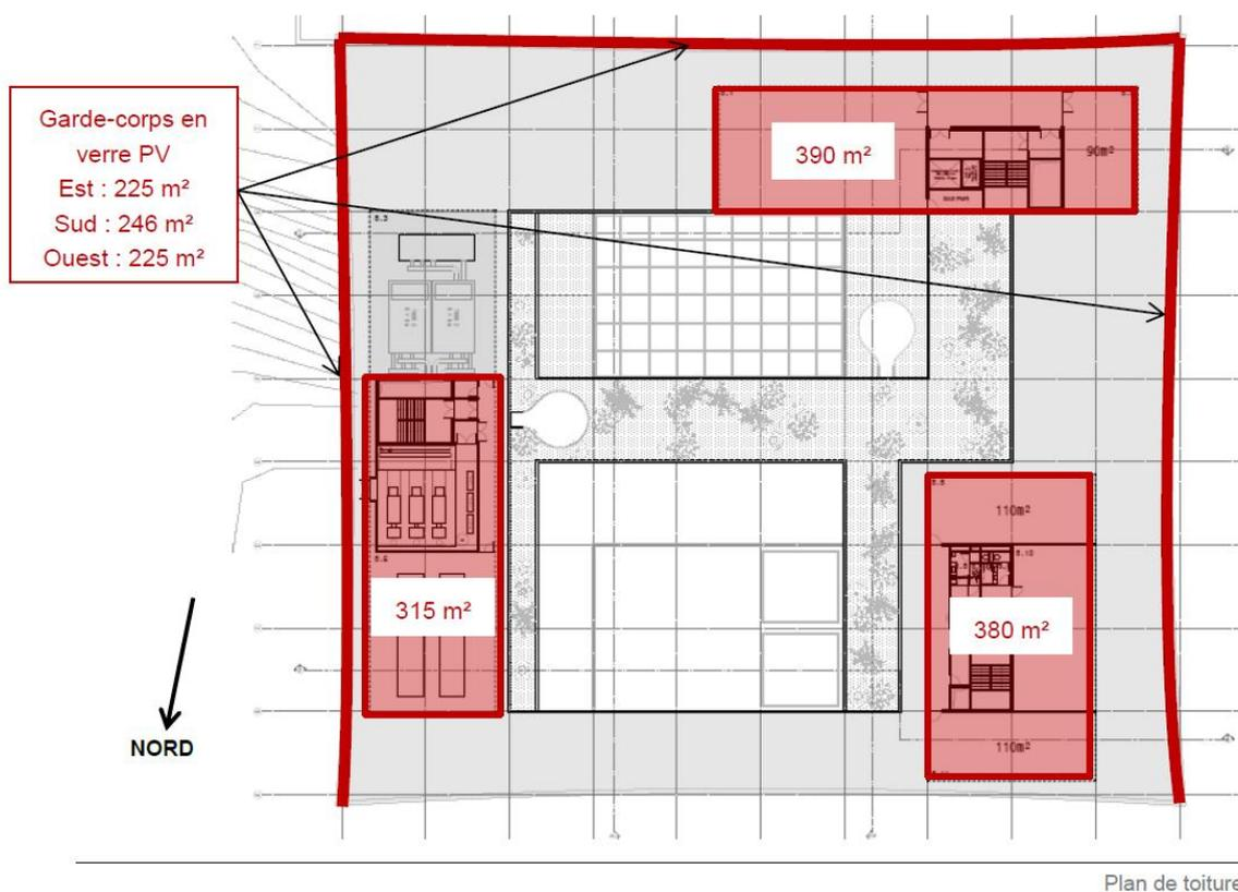
Figure 6 : Plan de la toiture avec les zones envisageables pour les panneaux PV (Source : EFI)
