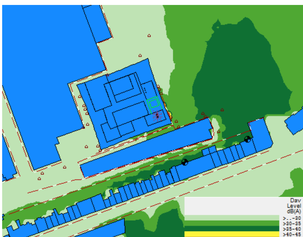
Figure 10 : Niveaux de bruit calculés à 4 m au-dessus du terrain (situation 2 – uniquement groupes électrogènes)
