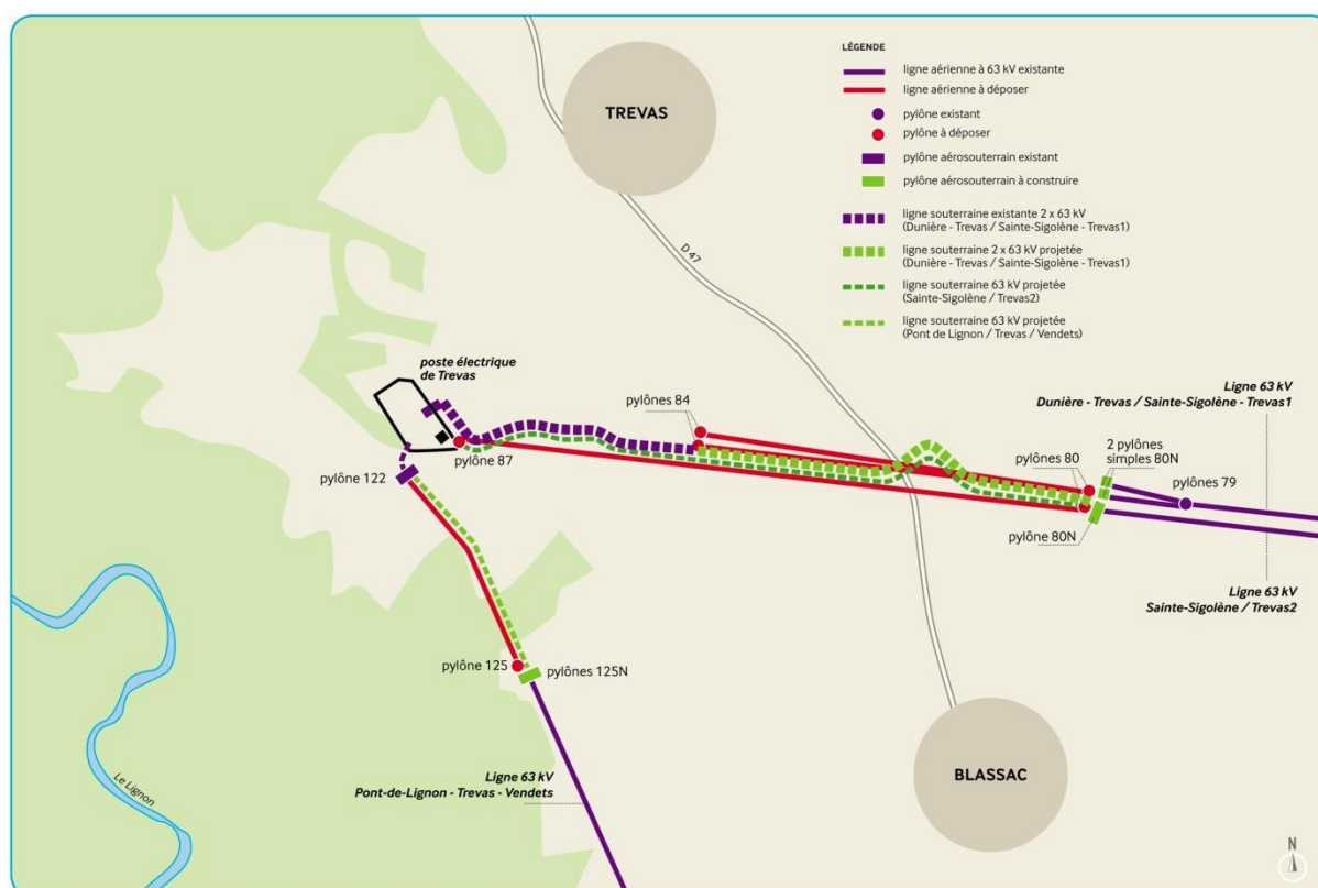
Mise en souterrain partielle des lignes électriques aériennes 63 000 volts au poste de Trevas
