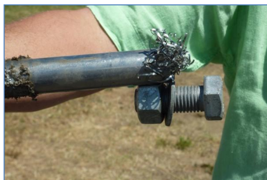
Récupération de copeaux à l'aide d'un aimant
