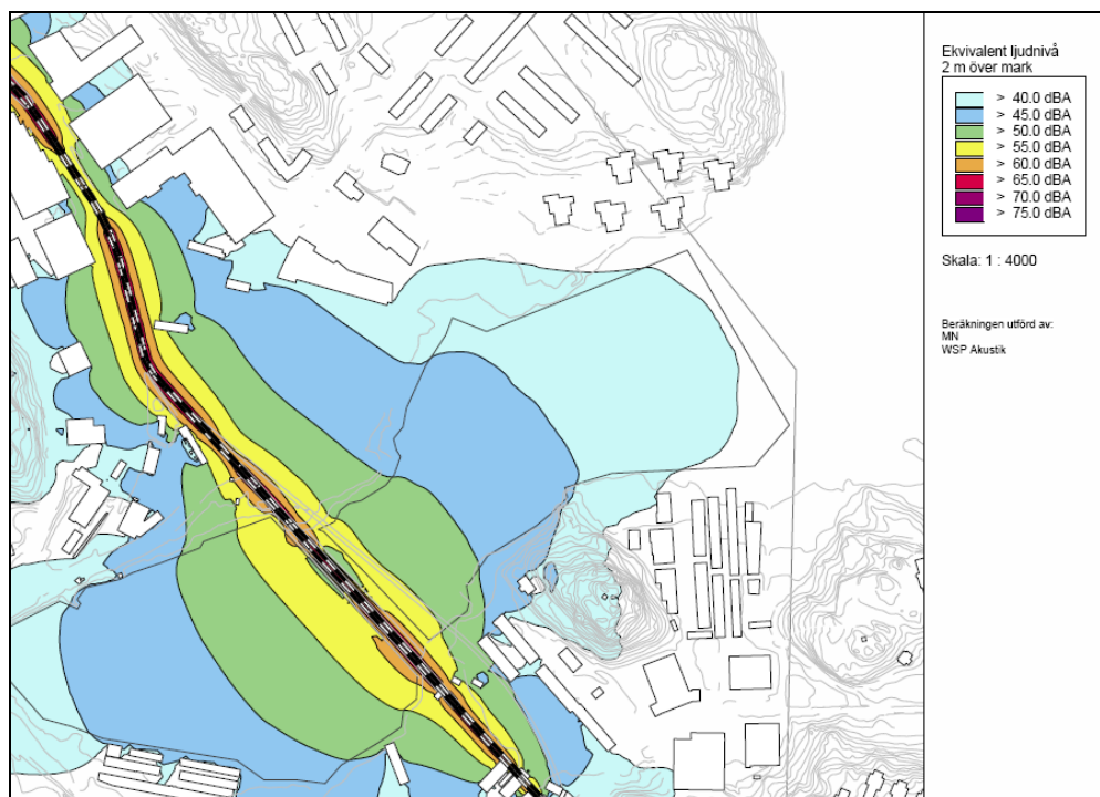
Figur 8 Bullerberäkning för ekvivalenta ljudnivåer längs planerad bro över Ulvsundaviken.
