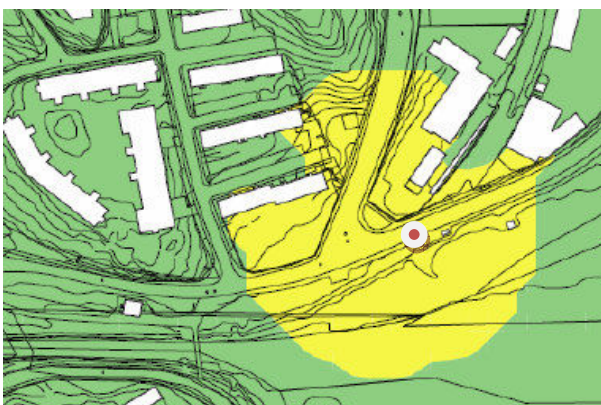
Figur 11. Inom gult område riskerar riktvärdet att överstigas vid pålning i position 3. Beräkningspositionen framgår av figuren. (WSP, 2009-03-19)
