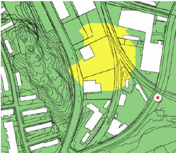
Figur 12. Inom gult område riskerar ljudnivån överstiga 45 dBA inomhus vid pålning i östra sidan av området. Beräkningspositionen framgår av figuren. (WSP, 2009-03-19)
