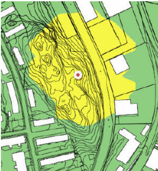
Figur 8. Inom gult område riskerar ljudnivån inomhus överstiga 45 dBA. Beräkningspositionen framgår av figuren. (WSP 2009-03-19).
