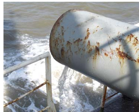
Figura 3.6 – Ao lado, o sistema de Overflow da draga Arangwa da EMODRAGA. Pode também ser visto o guindaste que controla o braço mecânico de sucção. Em cima, o detalhe da saída do Overflow. Consultec, 2006
