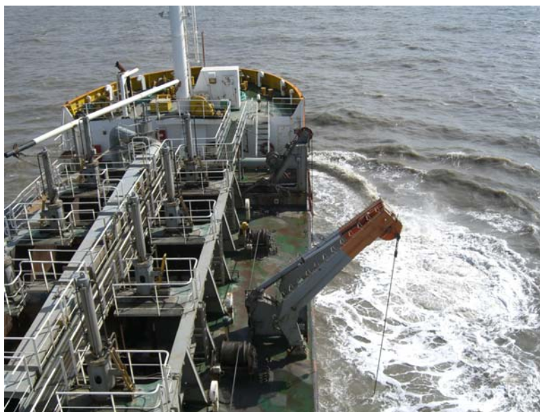
Figura 3.6 – Ao lado, o sistema de Overflow da draga Arangwa da EMODRAGA. Pode também ser visto o guindaste que controla o braço mecânico de sucção. Em cima, o detalhe da saída do Overflow. Consultec, 2006
