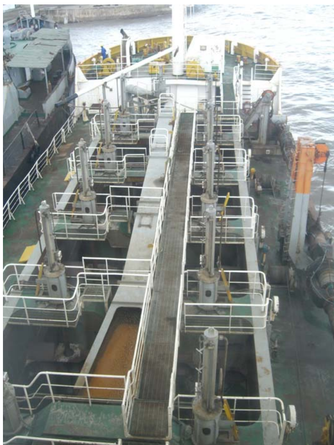
Figura 3.4 – Esquema de uma draga hidráulica de sucção auto-transportadora, semelhante a utilizada actualmente pela EMODRAGA nas suas dragagens de manutenção dos canais portuários.
