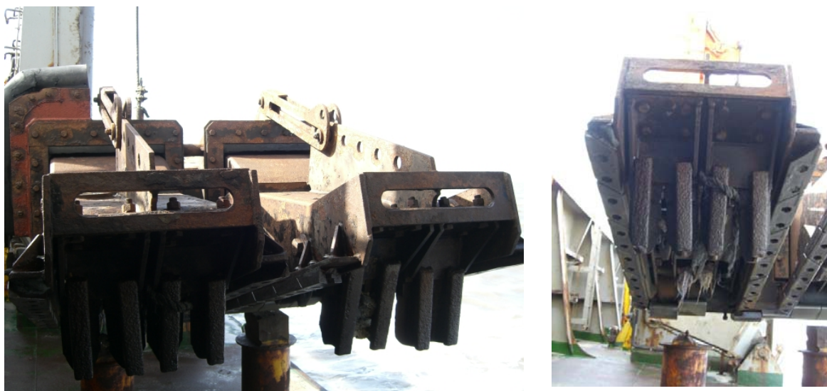
Figura 3.3 – Exemplo de um bocal de aspiração, utilizada pela EMODRAGA em suas dragas hidráulicas. Consultec, 2006
