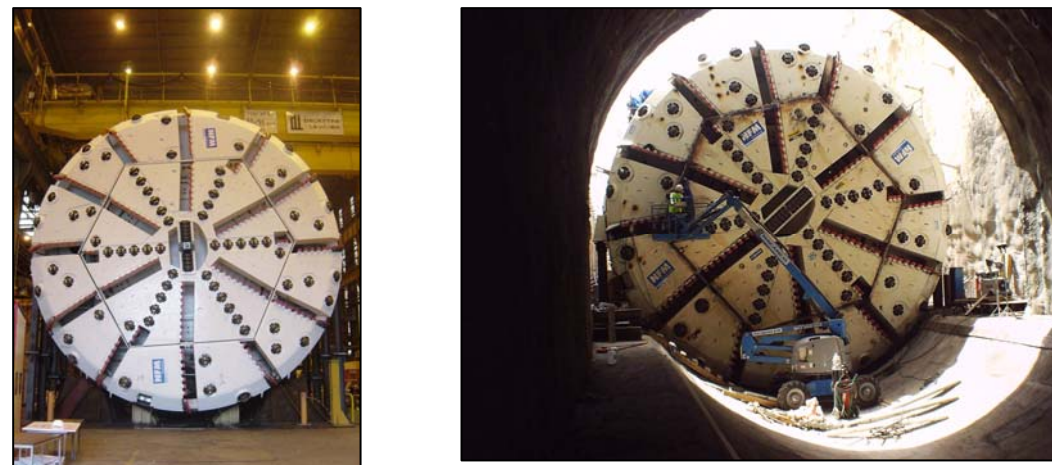
Figura 2: Tuneladores en roca utilitzades en la L9 de Metro.
