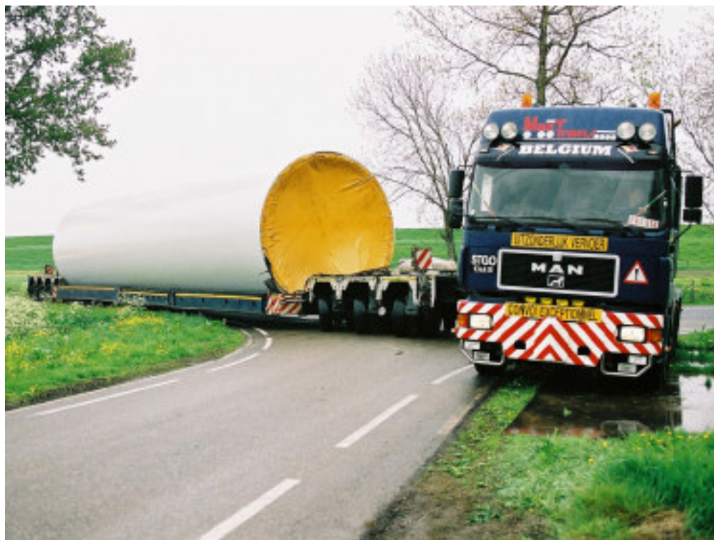
Aspect din momentul transportului unui tronson de turn (turbina G.E. 2,5 MW)
