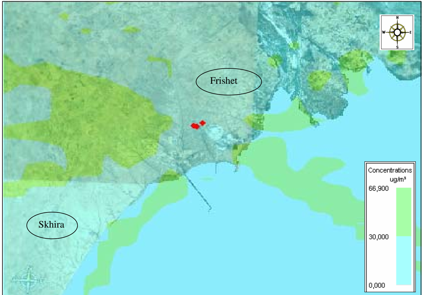
Figure 767676 : Répartition de la concentration max sur 24 heures en SO 2 (Période hivernale) – Skhira TIFERT + Skhira GCT (Effet cumulé)
