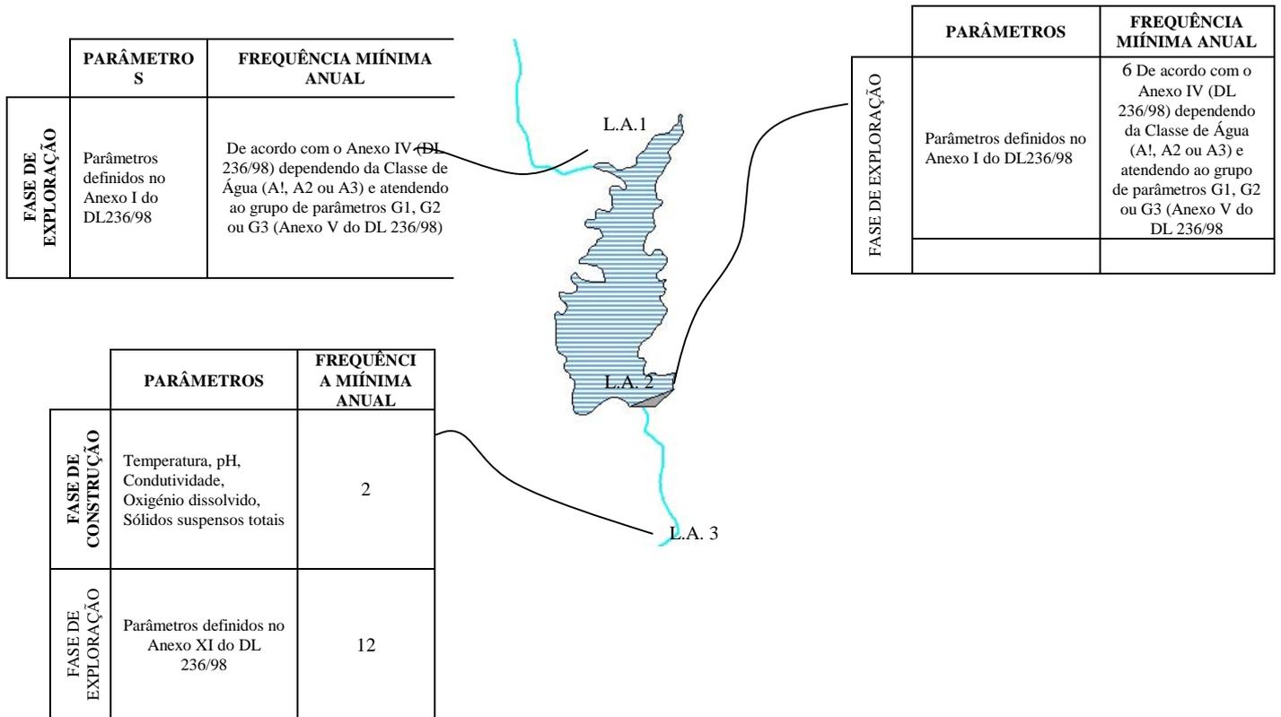
Figura 6 - Síntese das diretrizes para o plano de monitorização da qualidade da água da barragem de Torre de Pinhão
